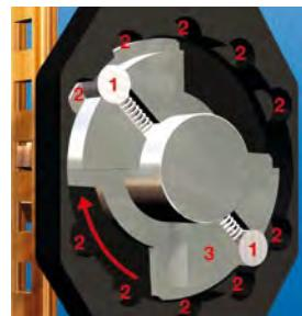
Dok se ručica obrće, sigurnosni šipovi **①** prenose se pomoću elementa za sprezanje **③** u pojedinačne žlebove **②**, proizvodeći zvuk.
