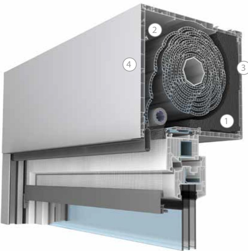
① **Visokokvalitetna izolaciona ispuna** od Neopor®-a omogućava izvrsnu topotnu izolaciju sa najvišom vrednosti do  $U_{sb} = 0,74 \text{ W}/(\text{m}^2\text{K})$ . Poklopac roletne je takođe ispunjen istim materijalom, tako da pruža izvrsnu izolaciju. Moguće je osigurati i zvučnu izolaciju (do 44 dB).
