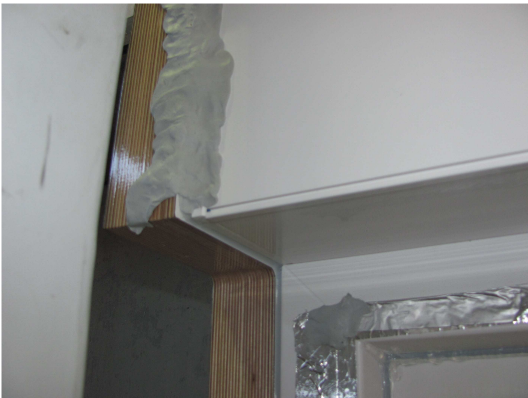
Bild 3 Prüfaufbau Messung der Luftdurchlässigkeit „Frontblende überputzt“
