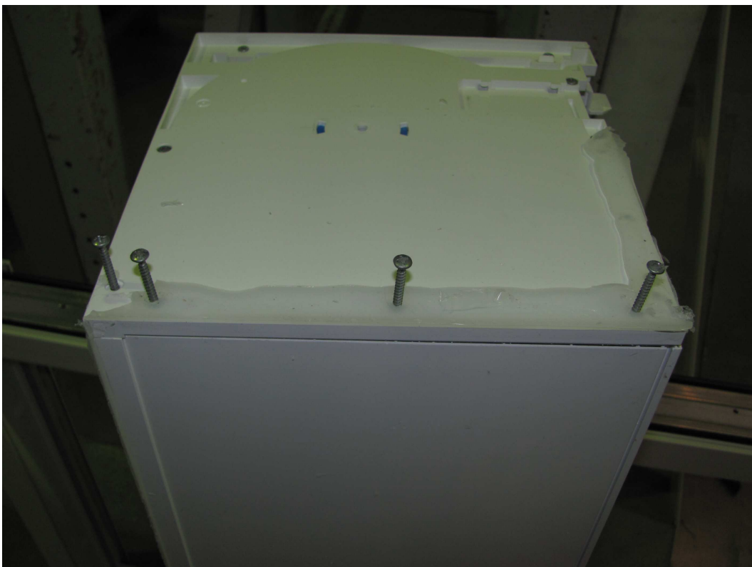
Bild 9 Verschraubung Frontblende (3-mal \varnothing 3,6 mm x 36 mm)
